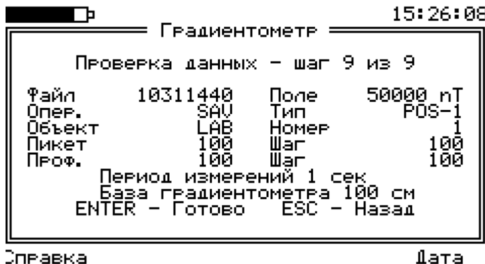
Рис. 33. Проверка параметров съемки в режиме градиентометра
