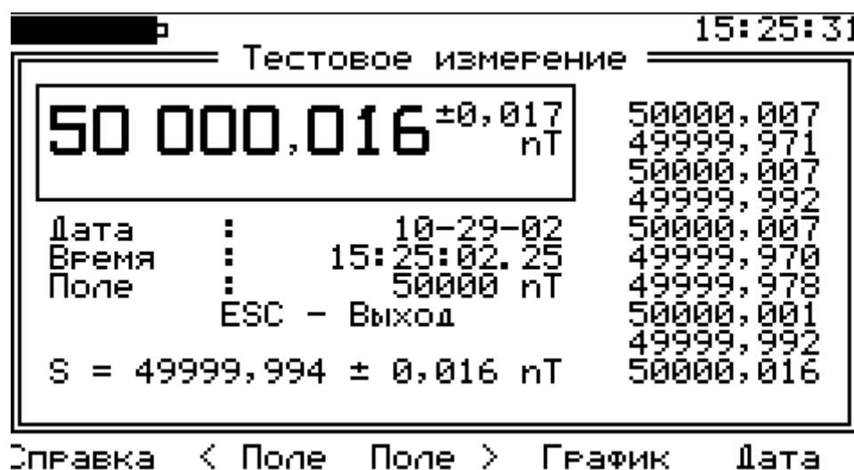
Рис. 12. Режим тестовых измерений модуля индукции магнитного поля
