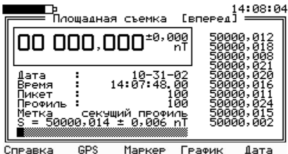
Рис. 29. Выбор метки измерения в режиме площадной съемки
