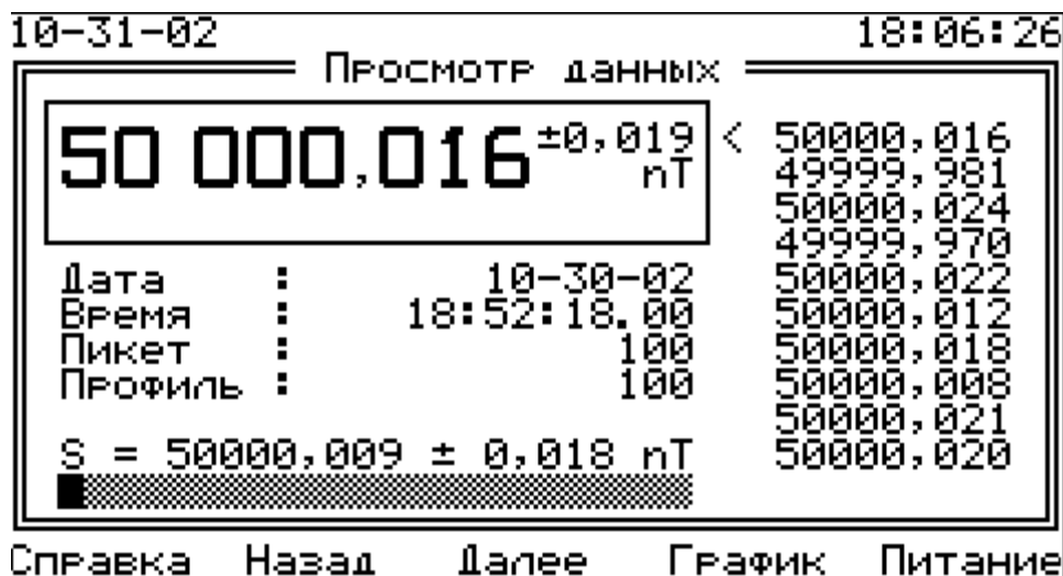
Рис. 40. Просмотр данных площадной съемки в рабочем окне режима
