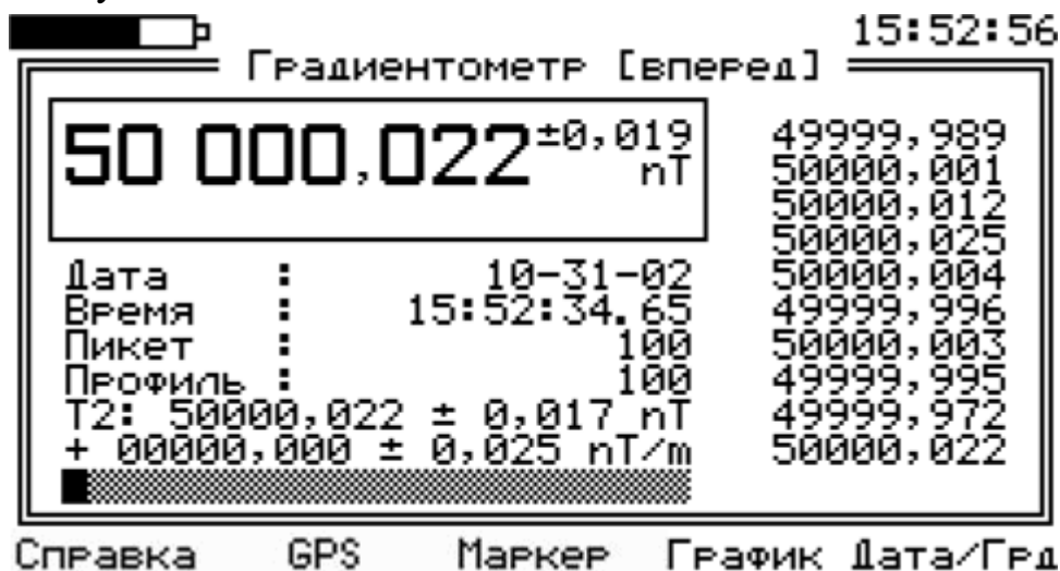
Рис. 35. Рабочее окно режима градиентометра
