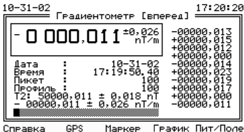
Рис. 37. Контроль градиента магнитного поля
