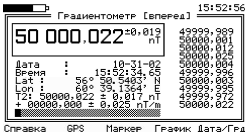
Рис. 36. Рабочее окно режима градиентометра (ГНСС включен)
