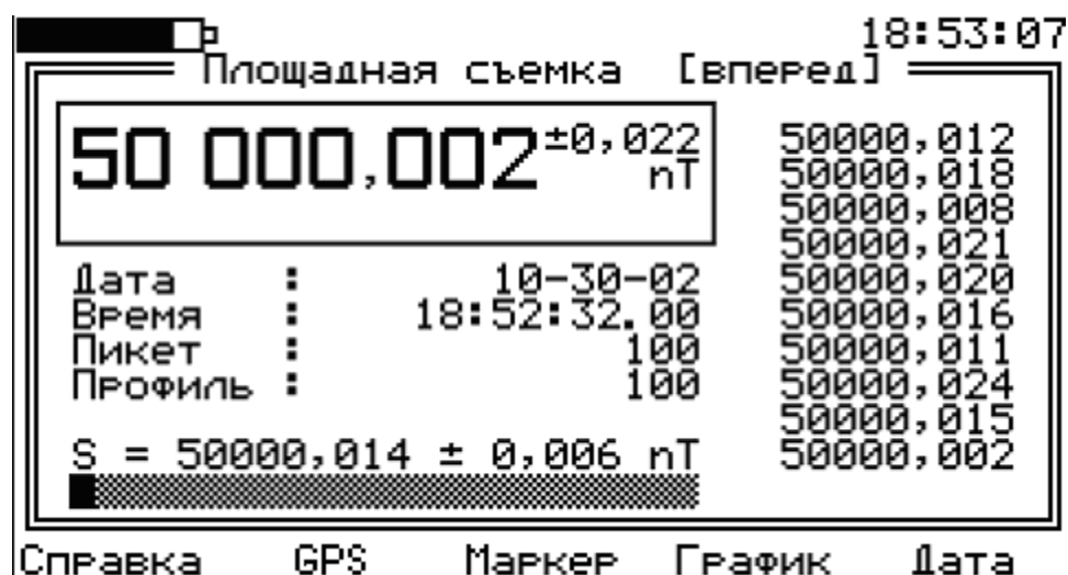
Рис. 28. Рабочее окно режима площадной съемки
