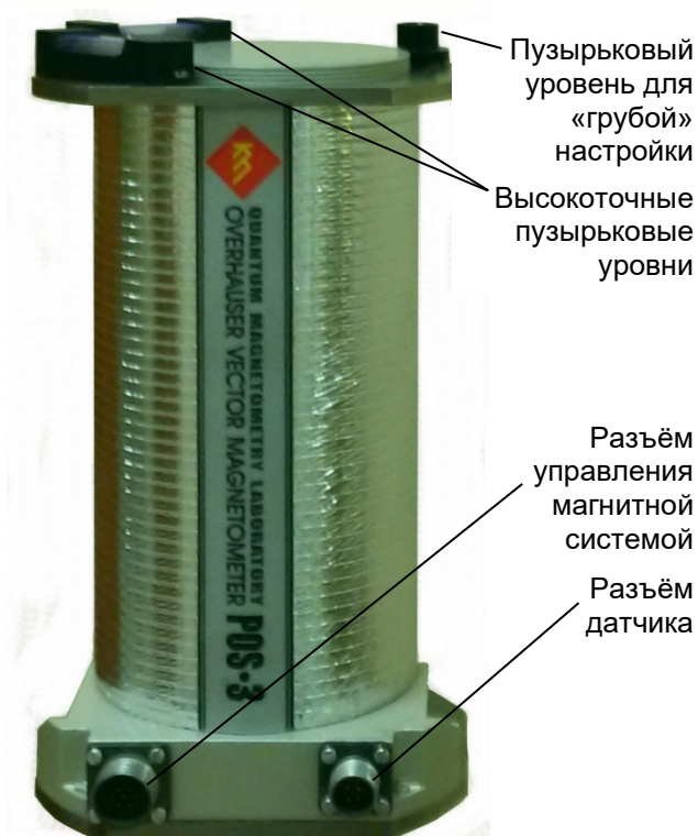
Рис. 4. Подмагничивающая система магнитометра POS-3
